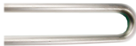
熱交換器內部銅管鍍鎳處理
